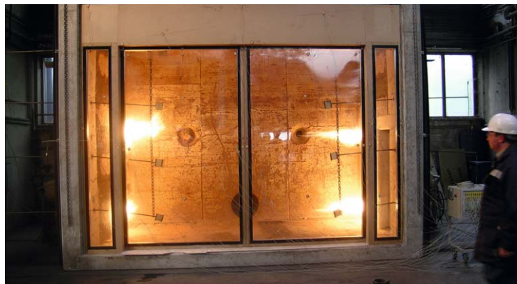
Brandversuche – für Sturm Feuerschutztüren die Probe für den Ernstfall und der Abschluss von vielen Monaten Entwicklungsarbeit.
